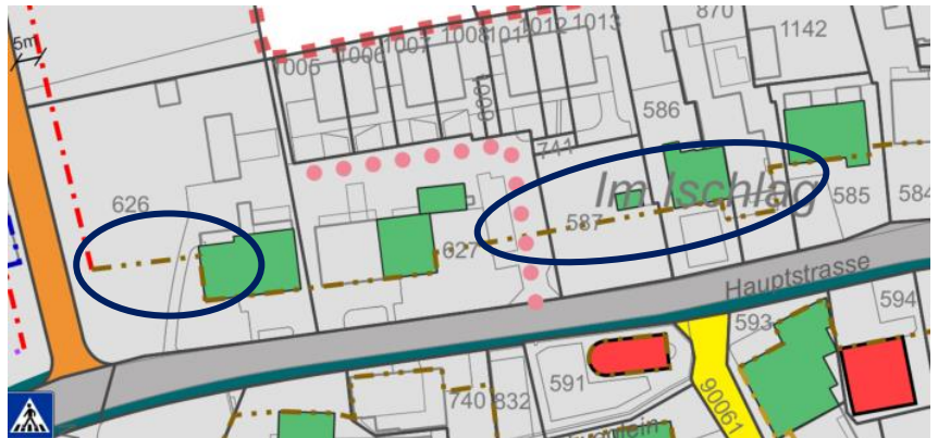
Abbildung 40: Reduktion der Gestaltungsbaulinien entlang der Hauptstrasse
