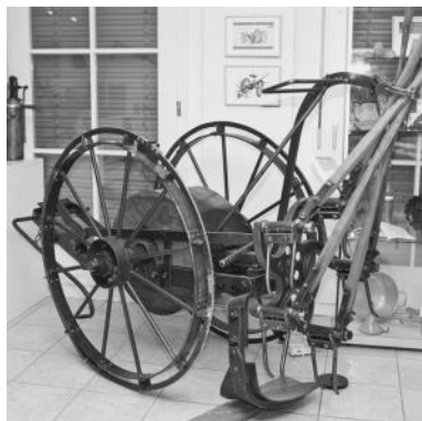
Kartoffelgraber mit Bodenantrieb aus der Wende vom 19. zum 20. Jh.
